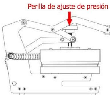
Ajuste la presión girando la perilla en sentido horario para aumentar la presión y en sentido contrario a las agujas del reloj para disminuir la presión.
